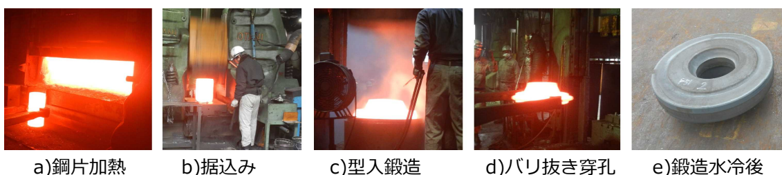
第1図 フランジの鍛造状況
