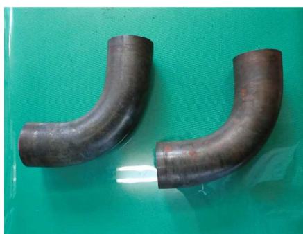
第 4 図 従来曲げ加工による普通鋼エルボ
