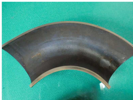
第 5 図 従来製法エルボの断面
