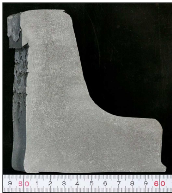
第4図 プレス品の断面マクロ組織
