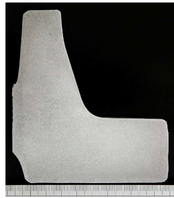
第5図 ハンマー品の断面マクロ組織
