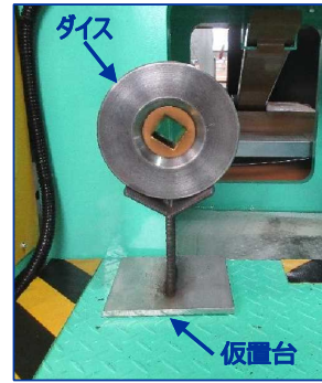
ダイス仮置き台を製作 → スムーズな吊上げ
