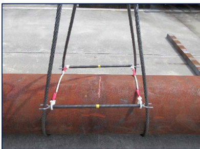
長尺品のセンター出し治具
